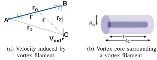
Fig. 2 Wake vortex filament
