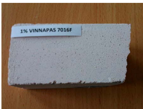
Fig. 6 Geopolymer mortar specimens containing 1% VINNAPAS® 7016 F
