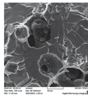
(d) Final rupture – transcrystalline cleavage
