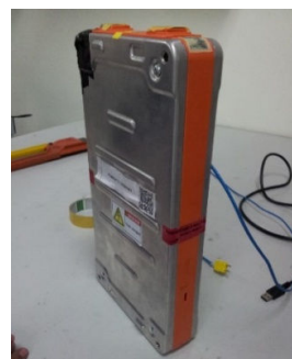
Fig. 2 Li-Ion Battery Module
