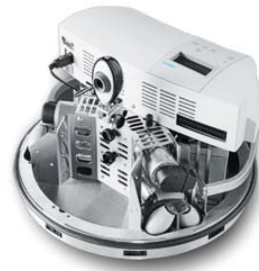
Fig. 3 Festo Robotino mobile robot
