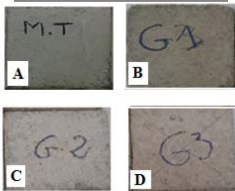
Fig. 4 (A) Mortar test MT, (B) Mortar-60%-sawdust 40%-G 1 , (C) Mortar-60%-sawdust 40%-G 2 , (D) Mortar-60%-sawdust 40%-G 3
