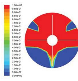
Fig. 3 (d) Melt Contour at 800 sec
