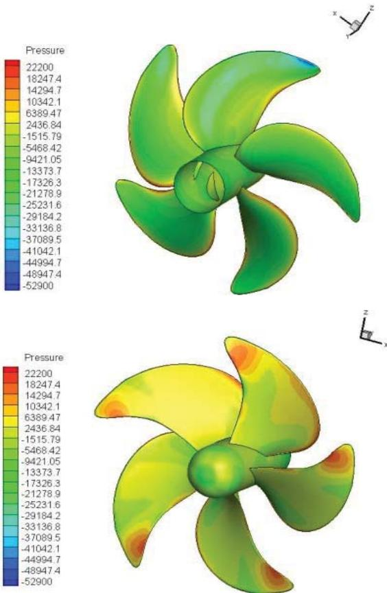
Fig. 9 Pressure contours for Seiun Maru HSP
