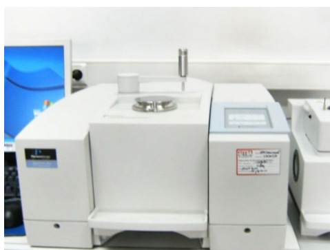
Fig. 3 Perkin Elmer Spectrum One FT-IR Spectrometer
