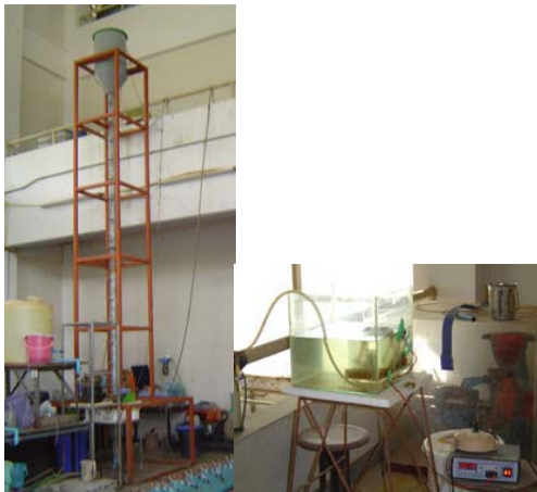
a) EGSB system b) Biogas meter
