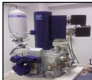
Fig. 3 Cam Scan- Apollo 300 SEM
