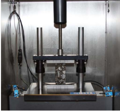
Fig. 5 IDT test setup
