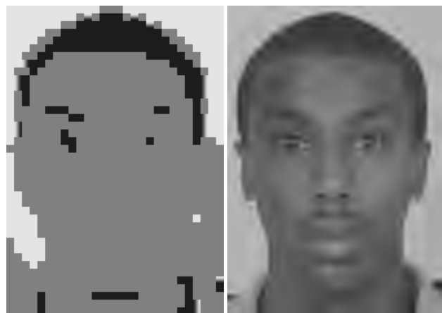
Fig. 7 a) decoded image, JPEG, 0,14 bpp, PSNR 16,8 dB.; b) decoded image JPEG2000, 0,05 bpp, PSNR 31,7 dB
