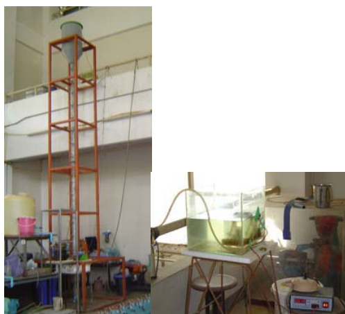
a) EGSB system b) Biogas meter
