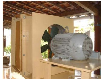
Fig. 5 Centrifugal fan
