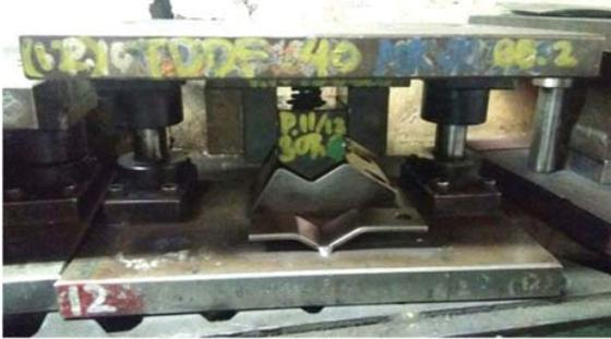
Fig. 7 QDC Die (courtesy of PT.SPI)
