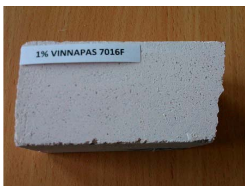
Fig. 6 Geopolymer mortar specimens containing 1% VINNAPAS ® 7016 F
