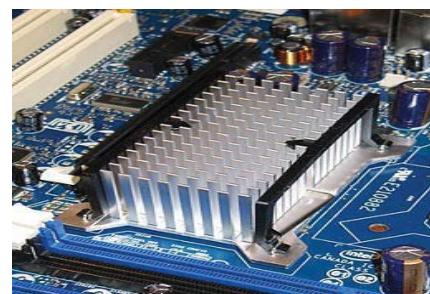
Fig. 1 Pin fin heat sink
