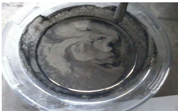
Fig. 1 Cement- MWCNTs & DI water paste
