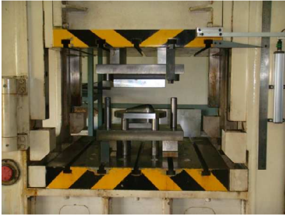
Fig. 5 Installation of die on 80 ton hydraulic press
