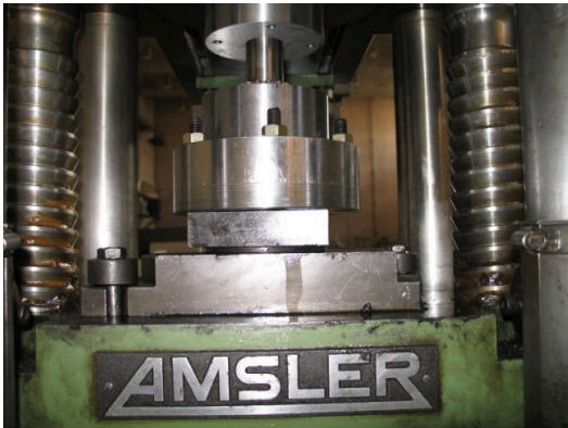
Fig. 5. gear forging die set.
