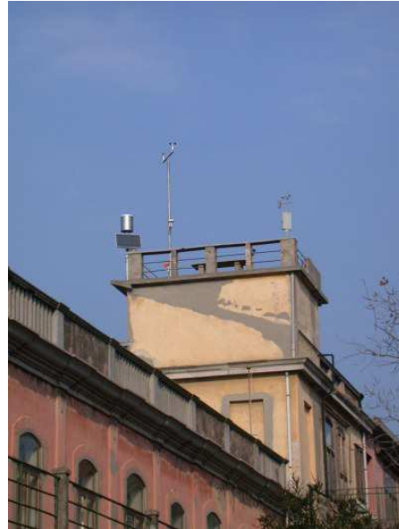
Fig. 3 View of the anemometric station on top of the "Osservatorio Bioclimatologico dell'Ospedale al Mare di Venezia"
