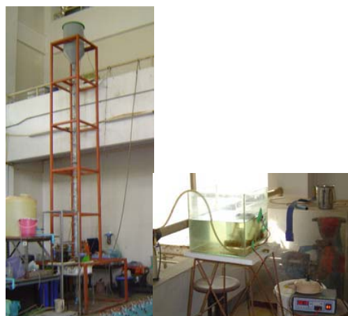
a) EGSB system b) Biogas meter
