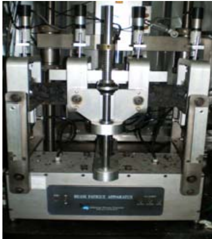
Fig. 2 Beam fatigue apparatus
